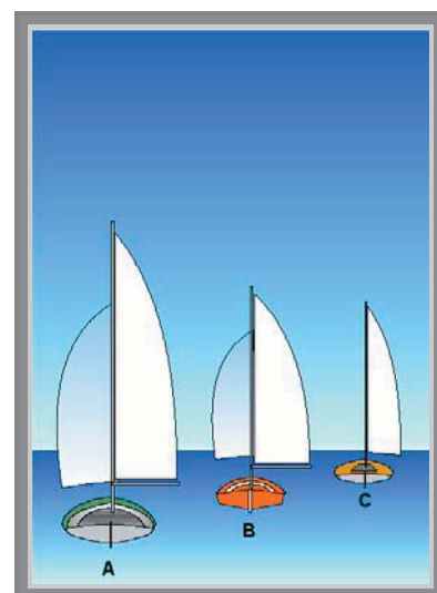
Tre joller af forskellig konstruktion A) rundspants tomands jolle B) knækspants tomands jolle C) rundspants enmands jolle
